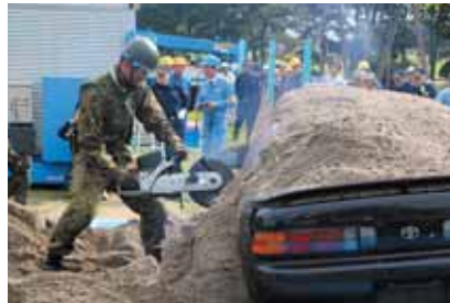
▲開かなくなったドアをエンジンカッターで切断
