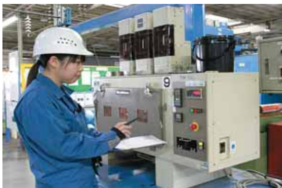
電線に使われる絶縁材料の加熱変形試験を行う望月さん
